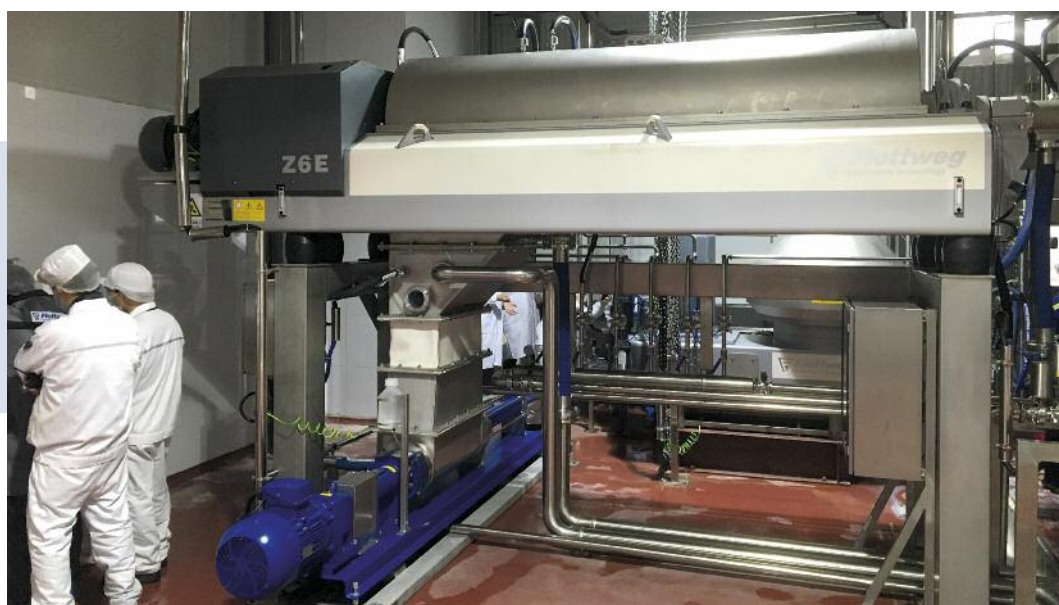
Decanter, modelo Z6E, trabajando en la producción de leche de soja
